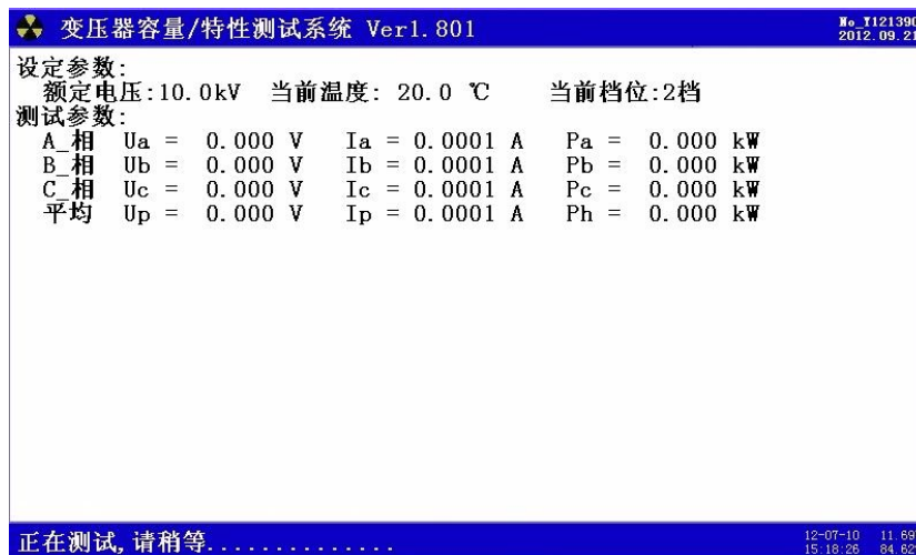
图 5、容量测试（进行中）
